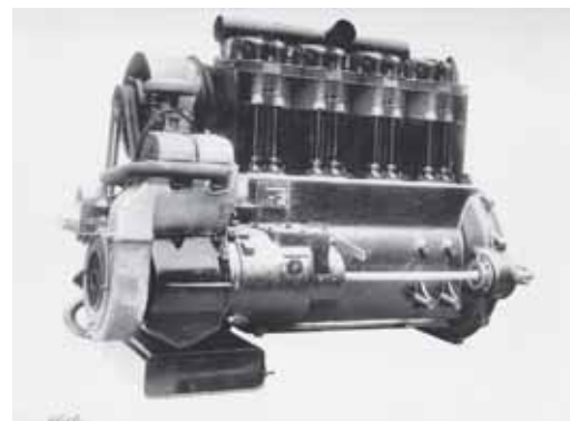
Prvním úkolem ing. Mackerleho pod vlajkou kopřivnické Tatry bylo vylepšení vznětového motoru Tatra T111 s přímým vstřikem paliva
