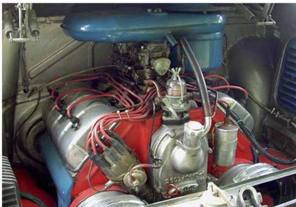
Motor T 603 je vzduchem chlazený osmiválcový motor V8 o obsahu 2545 cm 3 a s výkonem 95 koní, jehož autorem byl ing. Julius Mackerle
