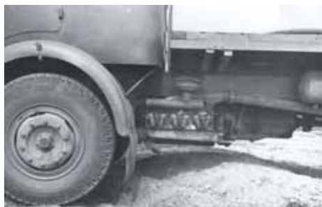
Motor T116 byl umístěn téměř ve středu vozidla pod rámem a ložnou plochou. Jednou z jeho velkých výhod byl snadný přístup, který je jasný z fotografií.
