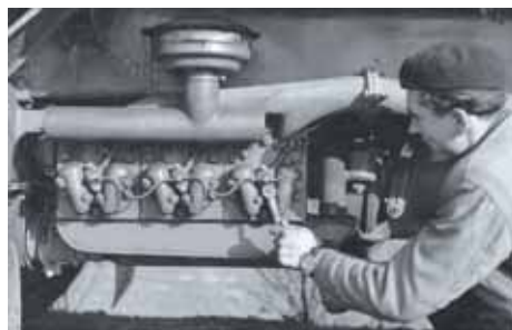
Motor T116 byl umístěn téměř ve středu vozidla pod rámem a ložnou plochou. Jednou z jeho velkých výhod byl snadný přístup, který je jasný z fotografií.
