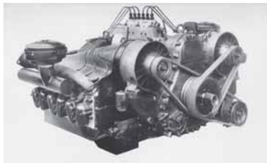
Šestiválcový plochý motor T 116 s vrtáním 120 a zdvihem 150 mm, který při obsahu 10 180 cm 3 dával výkon 96 kW při 2000 ot/min.
